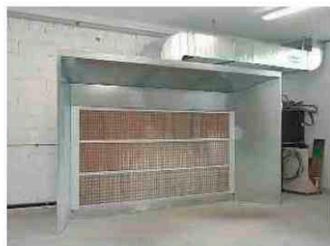
Postazione di spruzzatura KVH fino a 8.0 m di larghezza
