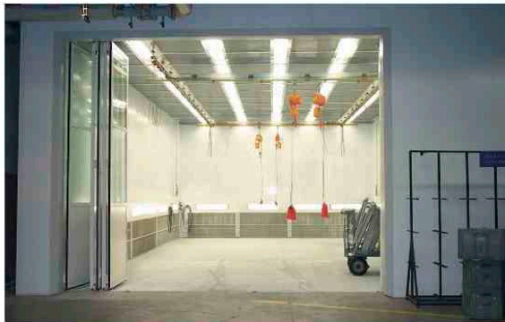
Cabina di verniciatura con elevatore, illuminazione e ricupero calore
