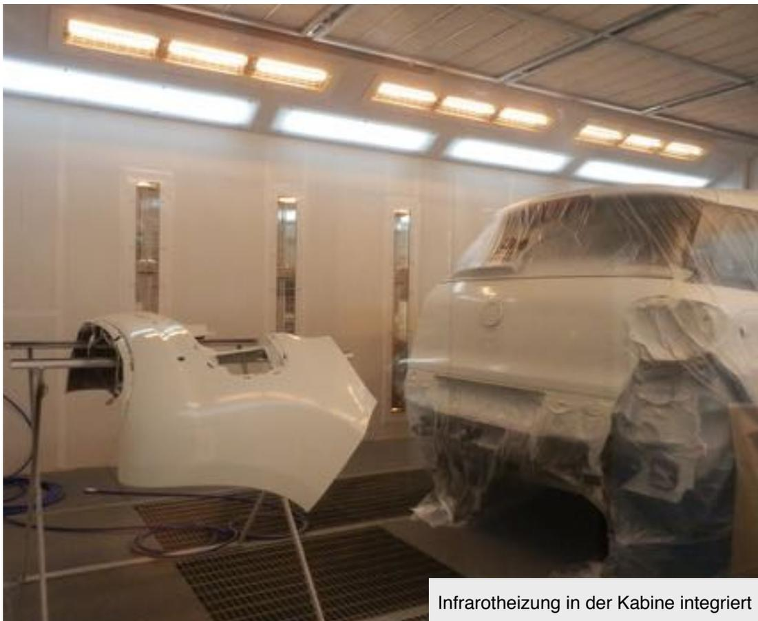
Infrarotheizung in der Kabine integriert
